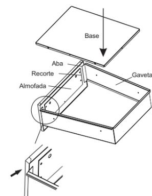
3) Fixe os parafusos A (3,9x9,5) na almofada, travando a gaveta. Utilize o parafuso B (3,9x9,5) para fixar a base na almofada. Encaixe a bucha branca e os parafusos C (3,9x9,5) juntos, no furo da almofada. Posicione o puxador e aperte os parafusos. Posicione o trilho menor, alinhando-o sobre os furos da lateral do gavetão. Utilize os parafusos D (M4x6) e as porcas M4 para fixar.
